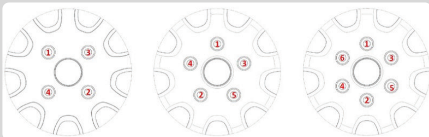
Fig.3 - Sequência de fixação
